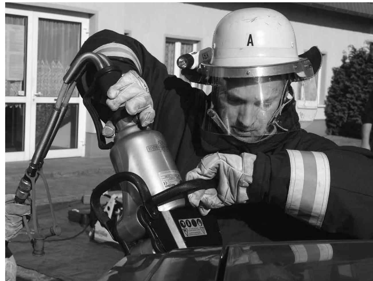
Praktische Ausbildung "Retten und Bergen", Umgang mit einer 19,4kg schweren Hydraulikspreizer | Neulewin | 8.3.2014
